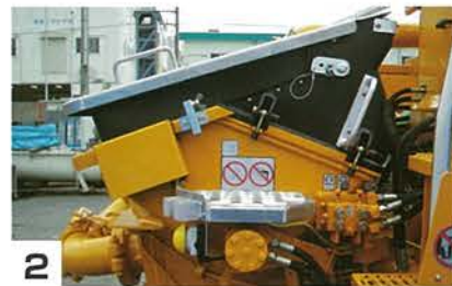
2 ホッパーグリッドを開けるとセンサーが感知しポンプ・アジテーター・S管動作停止。
