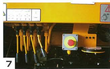
7 非常停止ボタン(シャシー両サイド・ホッパー横の3箇所) 水準器/アウトリガー操作レバー
