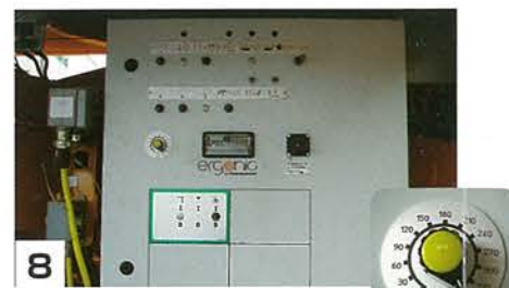
8 操作盤 リリーフ圧調整ダイヤル(打設現場状況に応じて最高圧を調整出来ます)
